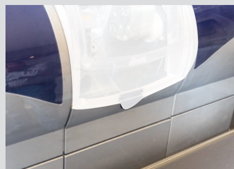
Bei geschlossener Schrankhaube bleibt der Gerätedeckel teilgeöffnet. Der Lüfter mit eingestellter Nachlaufzeit sorgt für die Beseitigung der Restfeuchte in der Geräteschleifkammer.
