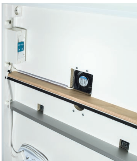
Das Stromrelais schaltet den Lüfter durch einen vorgegebenen Stromdurchfluss des Cerec-Gerätes ein
